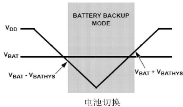
在后备电池供电模式中, IIC 总线通信功能持续允许, 实时时钟的读写功能均可实现。
