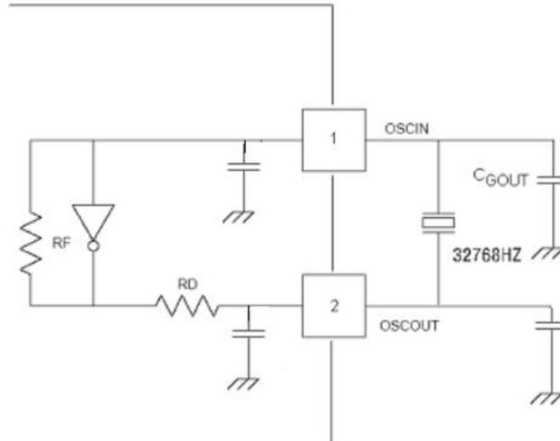
该电路可外配负载电容(CL)最小为 7PF 的 32768HZ 晶体(CGout 根据实际应用来决定是否需要添加)。
