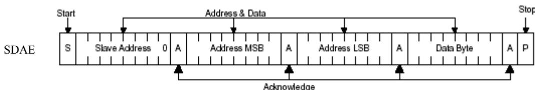
D型、E型和G型SD2200 SRAM单字节写操作
