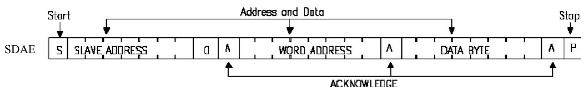
图30 B型和C型SD2200 SRAM单字节写操作
