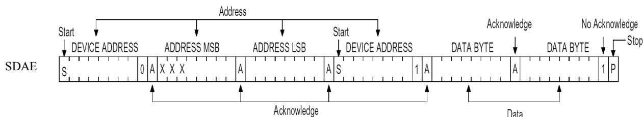
图33 D型、E型和G型SD2200的SRAM随机地址读操作
