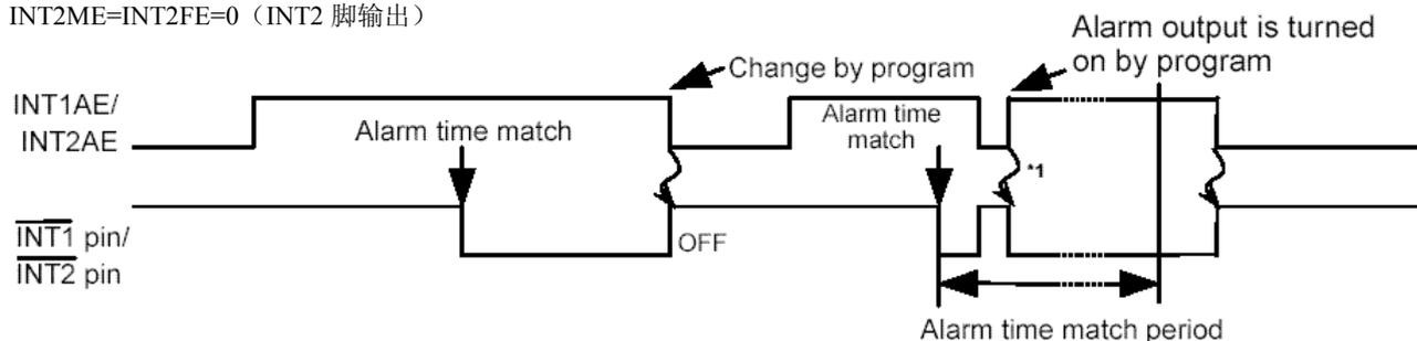
\*1、在报警时刻一致时，因程序的改变使报警输出变为 ON 的情况下，会再一次从  $\overline{\text{INT1}}$  脚（或  $\overline{\text{INT2}}$  脚）输出“L”。
