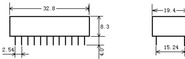
图 37 SD2200 系列系列封装尺寸 (管脚直径: 0.5mm)
