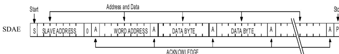
B 型和 C 型 SD2200 SRAM 连续写入操作
