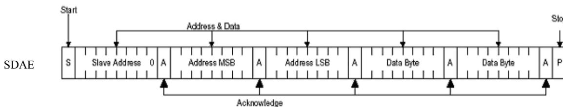
D 型、E 型和 G 型 SD2200 SRAM 连续写入操作
